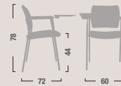
DR15 Sedia fissa con un bracciolo e scrittoio. Fixed chair with armrest and writing board.
